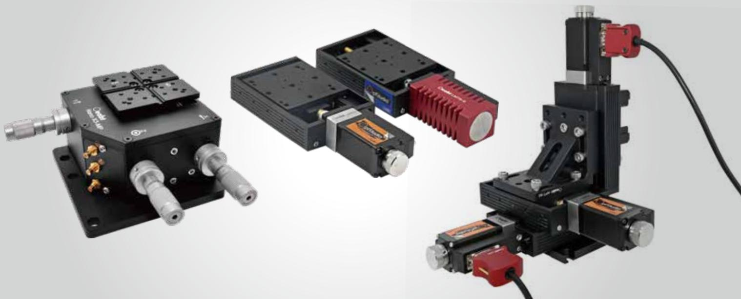
Oeabt的三轴Nano X3系列挠性位移台集成了开环压电驱动器,压电驱动器能够使位移台达到纳米分辨率。游标测微头调节器的Nano X3位移台提供4mm行程。压电驱动器提供20 $\mu$ m行程,可以使用我们开环压电控制器控制。平行挠性设计确保了精确、平滑、连续的运动,摩擦可以忽略。最大负载1 kg。
