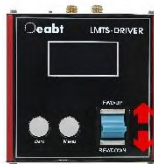
图4.8 向上或向下扳动摇杆控制电机双向连续运动（慢跑模式）
