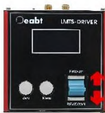
图4.9 向上或向下扳动摇杆连续调节参数数值（点动步距或行程数值）
