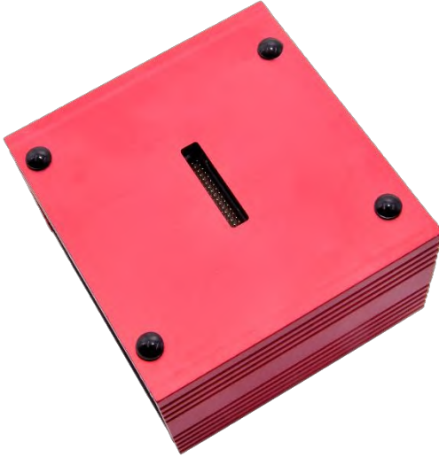
图3.1 拆除基板后粘贴橡胶脚
