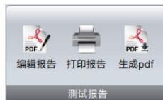
测试报告功能在BeamTester运行采集期间会被禁用。停止采集后，可以拖动软件右下角状态栏内的缓存池滑块，选择其中一帧图像来生成报告。报告包含了已选定的计算项目和结果，其中大部分结果是遵循ISO标准的计算方法而得到的。
