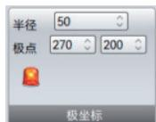
极坐标模式用于实时监控质心位置的稳定性。采用极坐标替代笛卡尔坐标系来对质心的位置进行定义，其中，极点默认为图形中心位置。
