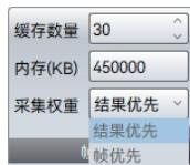
**Beamtester**开始工作时，会通过相机不断地采集图像，或通过光束合成器生成图像。图像会存放到一个双端队列中，这个队列的大小取决于帧缓存中缓存的图像数量，并可由用户自定义缓存图像的数量。如上图所示，用户设置了缓存数量为**30**（帧图像），表示可以缓存**30**张图像进行分析，如果队列满了将从第一个开始覆盖，只有在队列中的图像才能被分析和保存。
