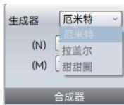
光束合成器是一种采用计算机仿真技术和专用算法,合成特定形态光束的功能。本版软件集成了厄米特、拉盖尔和甜甜圈三种光束生成器。
