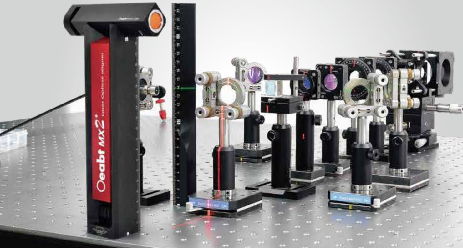
MX2 激光准绳仪是一种可大幅提高光路搭建效率的工具和仪表,它利用了激光亮度高、发散性小,准直度高的特性,以360°发散的激光光线为参考准绳,实现多种辅助测量和光路校准功能。其结构和功能具备独创性,现已申请国家发明专利,专利号:202010734498X。
