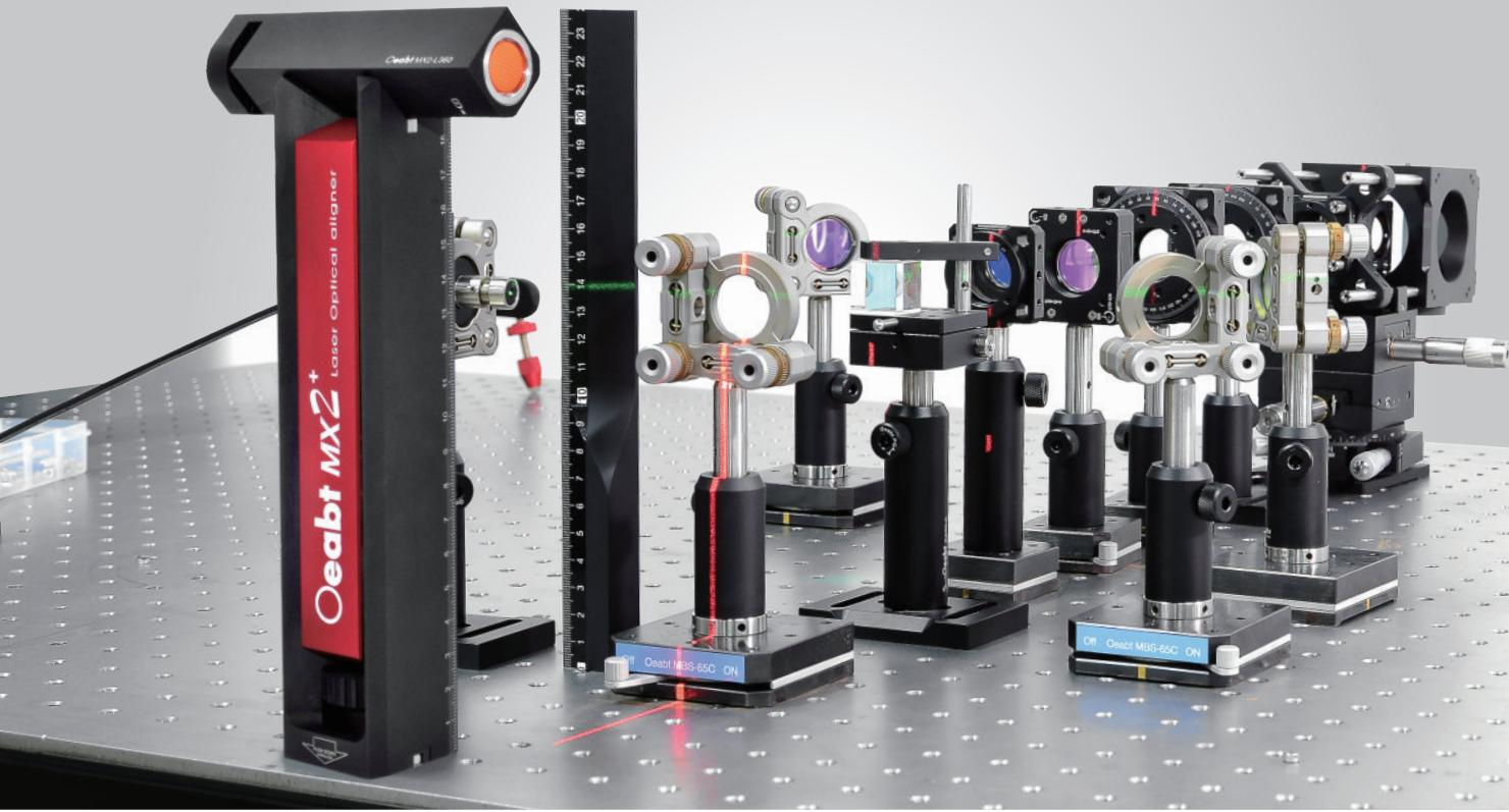
MX2 激光准绳仪是一种可大幅提高光路搭建效率的工具和仪表, 它利用了激光亮度高、发散性小, 准直度高的特性, 以360°发散的激光光线为参考准绳, 实现多种辅助测量和光路校准功能。其结构和功能具备独创性, 现已申请国家发明专利, 专利受理号:202010734498X。
